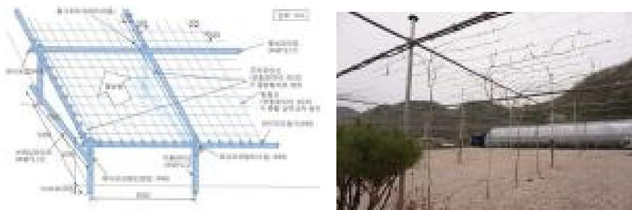
그림 8. 평덕 설치 설계 및 실제 설치 모습
