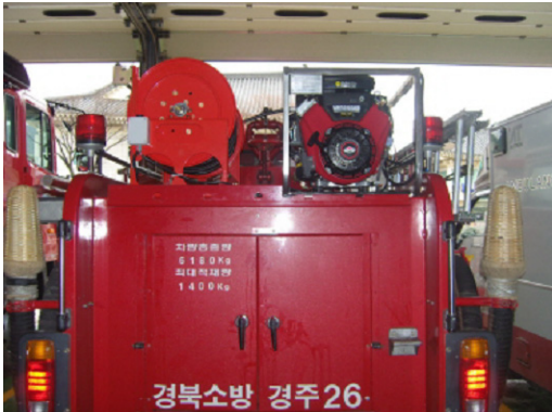
▲ 호스릴 설치 완료
